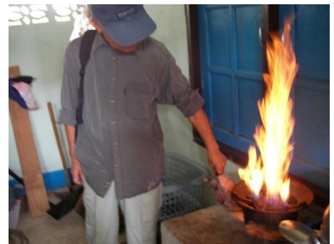
▲トイレの浄化槽から発生するメタンガス
