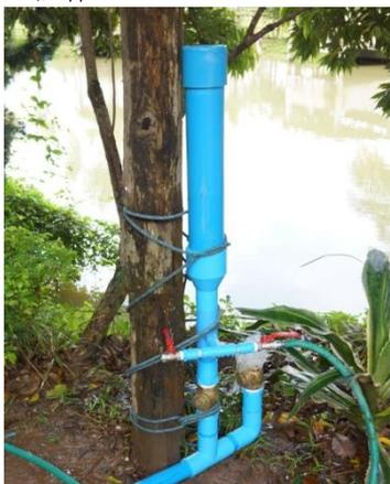
水源落差 1.5 尺での水撃ポンプ テスト
